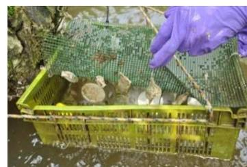
Cagette de protection des échantillonneurs et boîtes à Gammare
